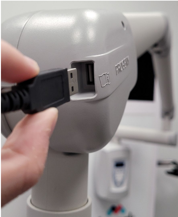
Figures 18. Brancher le capteur sur le port USB du bras articulé pour que le système soit intégré.
