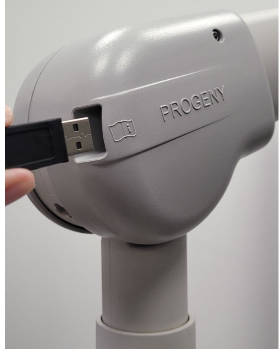
Figures 18. Brancher le capteur sur le port USB du bras articulé pour que le système soit intégré.
