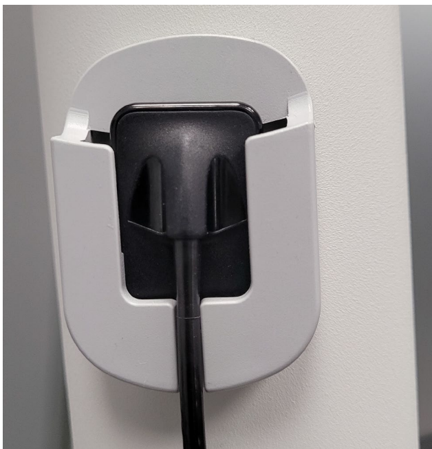
Figure 17. Exemple de porte-capteur installé sur un bras articulé (ici avec un capteur à l'intérieur).
